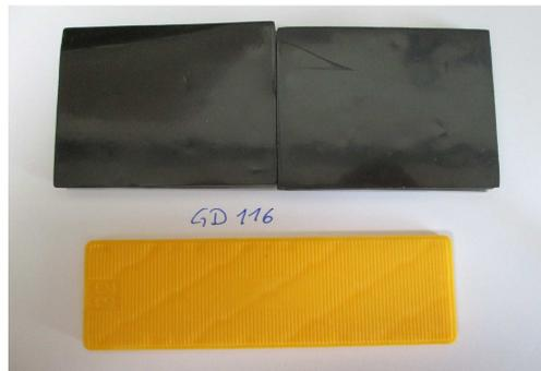
Bild 1 Probekörper vor Lagerung im Ofen bei 70 °C
