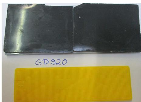
**Bild 1** Probekörper vor Lagerung im Ofen bei 70 °C
